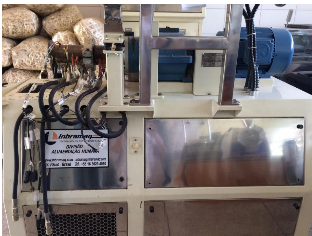
Figura 5. Extrusora (Imbramaq, PQ30, Ribeirão Preto, Brasil) utilizada para produção da farinha pré-gelatinizada de sorgo e de arroz.
